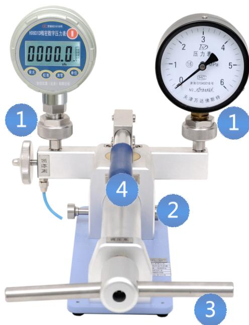
第一步：打开回检阀（1），将被检表与标准表连接在压力输出口上。
